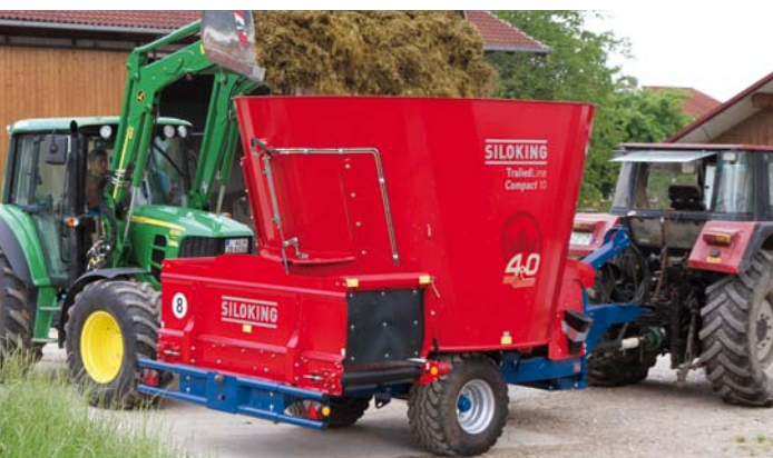
Der stabile Unterfahrtschutz mit integrierter Beleuchtung sorgt für Sicherheit bei Tag und Nacht.
